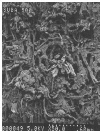
Fig. 6.2. Surface of a Type 1 Pad (Suba 500 TM )
